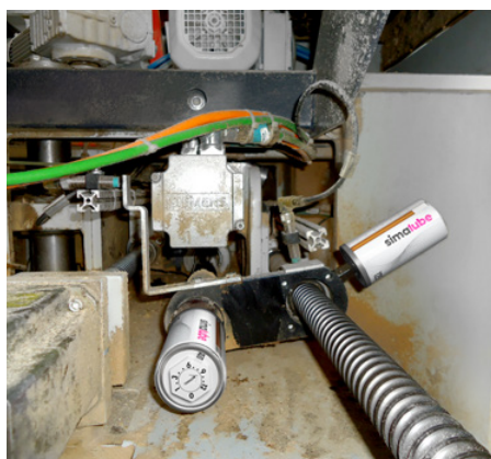
Le vis sans fin d'une scie circulaire est lubrifié de manière fiable avec deux simalube 125 ml.
