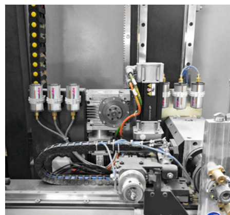
Six graisseurs fournissent le lubrifiant nécessaire aux guidages linéaires d'un centre d'usinage.
