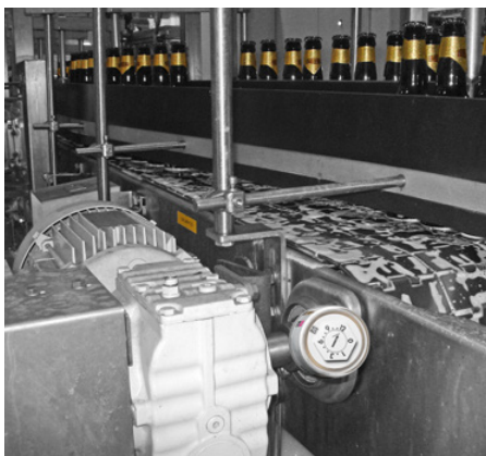
Lubricación de la cinta transportadora con un lubricador simalube.
