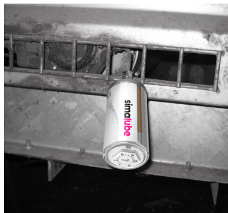
simalube schmiert das Wälzlager eines Förderbandes.
